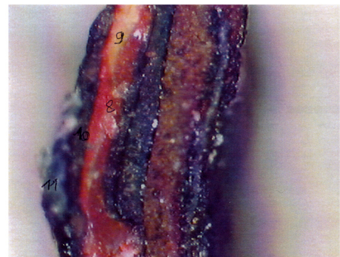
Clichés des prélèvements 8, 20 et 21 du Char montrant les différentes couches de peinture. Agrandissement x95.
